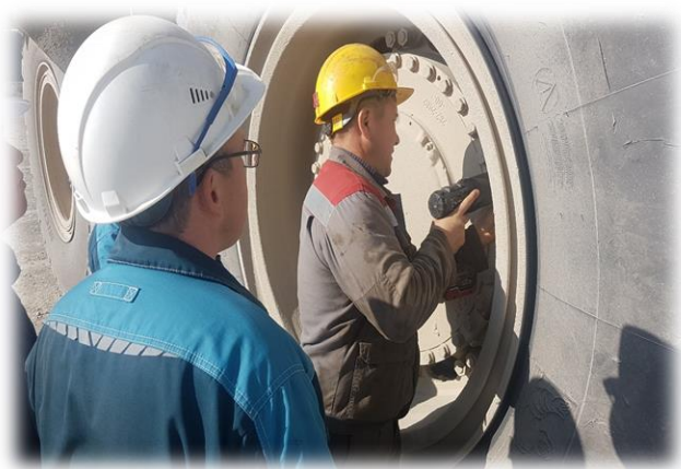
АО «Алтын Алмас» Гайковерт TorcUP VT (Volta) Крутящий момент от 670 до 8133Нм
